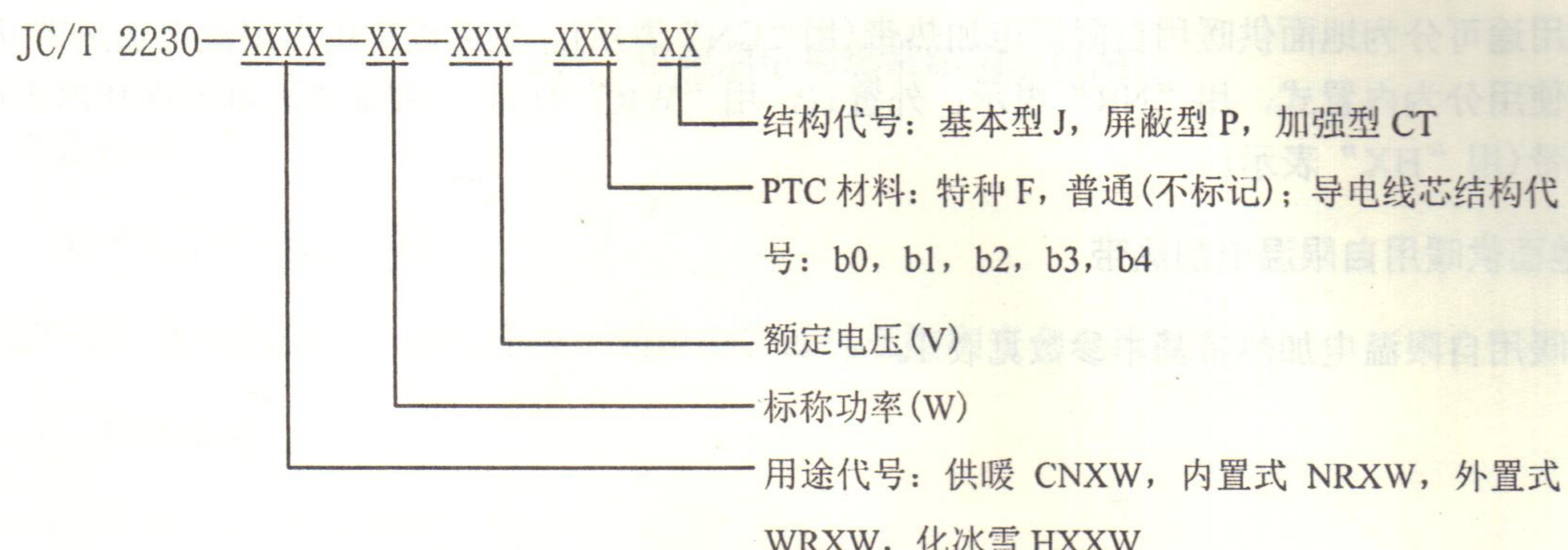
示例：符合本标准，地面供暖用，标称功率为 25 W/m，电压为 220 V，PTC 芯带材料为特种，导电线芯编织结构为 b1 的屏蔽型自限温电加热带为例，其标记为：
